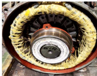
Bobinage stator : en bon état
