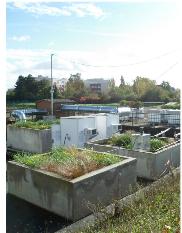
Pilote d'expérimentation (2x 16 m 2 de filtre 2 m 3 /sec d'air traités)
